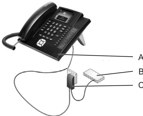
Abb. 5: Anschluss über PoE Injector
