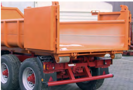
Kombinierte Heckklappe als Pendelbordwand mit eingebauter Doppelflügeltür, sog. „französische Heckklappe“
