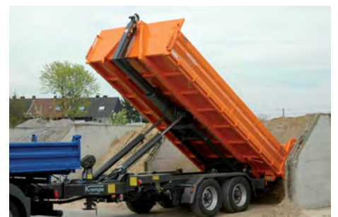
Der steile Kippwinkel von 49° lässt keine Wünsche offen.
