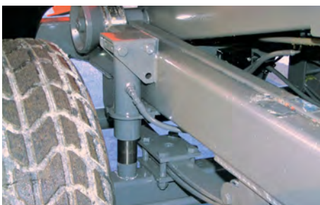
Option: Parabelfedern anstelle Luftfederung
