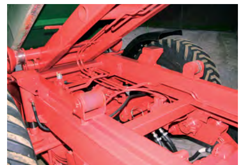
hydraulische Hinterachsabstützung zum Aufziehen von schweren Containern
