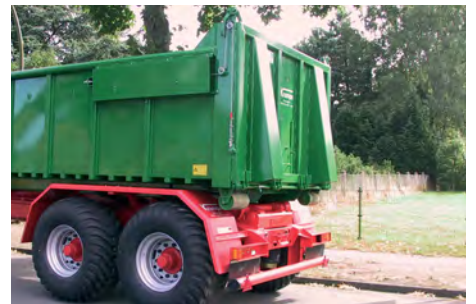
Überfahrbare Heckklappe für schweres Gerät
