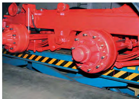
THL 16 Junior mit hängenden Achsen, dynamischem Achsausgleich und sehr niedriger Bauhöhe
