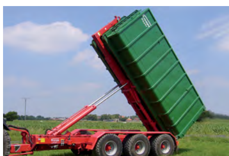
THL 23 L Ölversorgung vom Schlepper aus.
