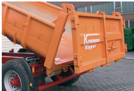
Kombinierte Heckklappe als Pendelbordwand mit eingebauter Doppelflügeltür, sog. „französische Heckklappe“
