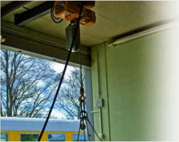
**Sensible Lastführung: KITO-Elektrokettenzug ER2 mit Elektrofahrwerk transportiert ICE-Stromabnehmer.**
