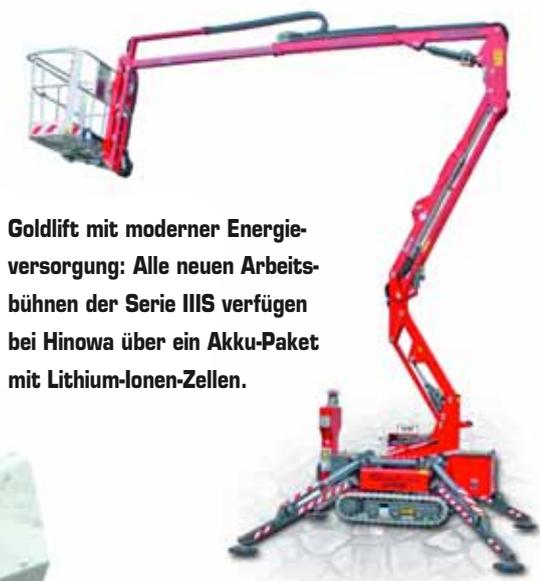
**Goldlift mit moderner Energieversorgung:** Alle neuen Arbeitsbühnen der Serie IIS verfügen bei Hinowa über ein Akku-Paket mit Lithium-Ionen-Zellen.
