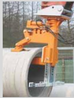
Automatische Aufnahme des Rohrlegers über Schnellwechselsystem des Baggers.
