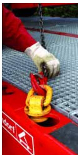
**Einfach: VarioLash richtet Zurrmittel automatisch in die optimale Zugrichtung.**
