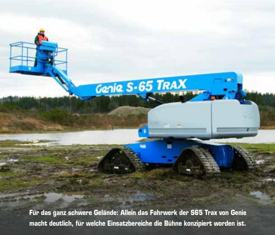
Für das ganz schwere Gelände: Allein das Fahrwerk der S65 Trax von Genie macht deutlich, für welche Einsatzbereiche die Bühne konzipiert worden ist.
