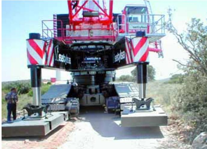
**Die Schmalspurraupe LR 1400/2-W von Liebherr ermöglicht über zwei Drehverbindungen das Verfahren des Gerätes auch auf engen Einsatzstellen.**
