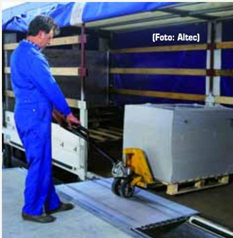
**Ladehilfe:** Die Überfahrbrücken von Altec helfen, Höhenunterschiede im Warentransfer zu überwinden.
