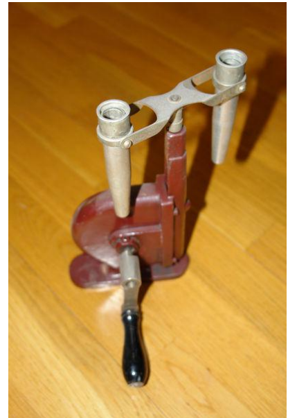
einfache Hand-betriebene Zentrifuge Q: de.wikipedia.org (Stephan M.Höhne)
