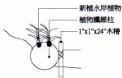
② 植物纖維護岸鋪設剖面示意圖
