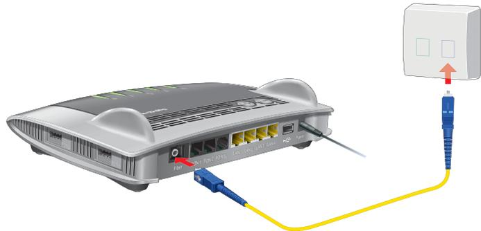
Am Glasfaseranschluss anschließen
