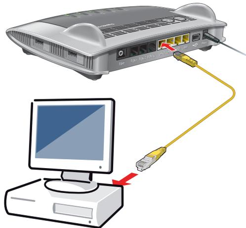
Anschluss eines Computers mit einem Netzwerkkabel
