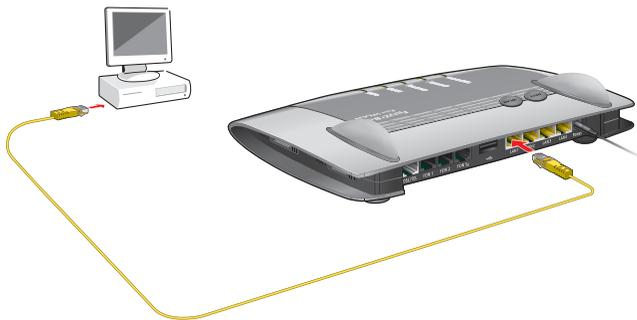
Anschluss eines Computers mit einem Netzkabel
