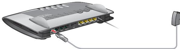
Anschluss mit DSL-Kabel
