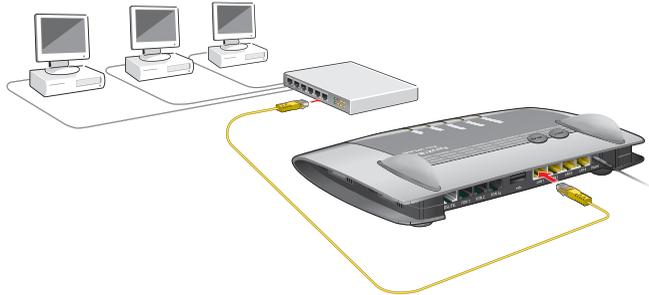
1. Stecken Sie das mitgelieferte Netzwerkkabel in den Uplink-Port des Netzwerk-Hubs oder Netzwerk-Switches.
