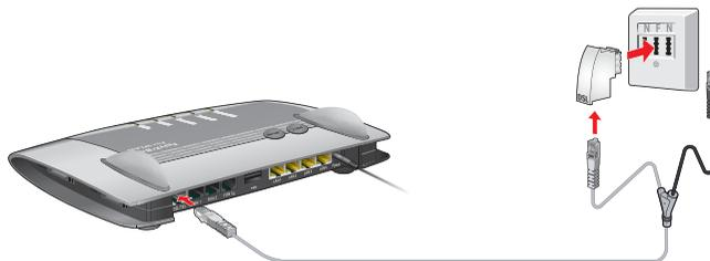
Anschluss mit DSL-/Telefonkabel und DSL-Adapter
