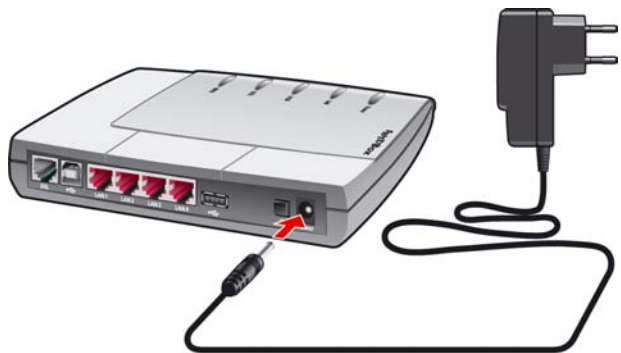
Anschluss der FRITZ!Box an die Stromversorgung
