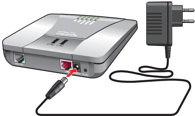
Anschluss an die Stromversorgung
