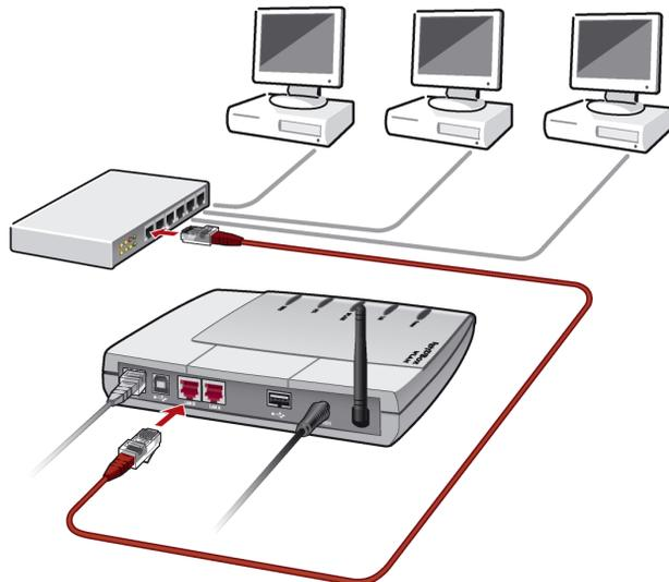
*Anschluss der FRITZ!Box WLAN an einen Netzwerk-Hub*
