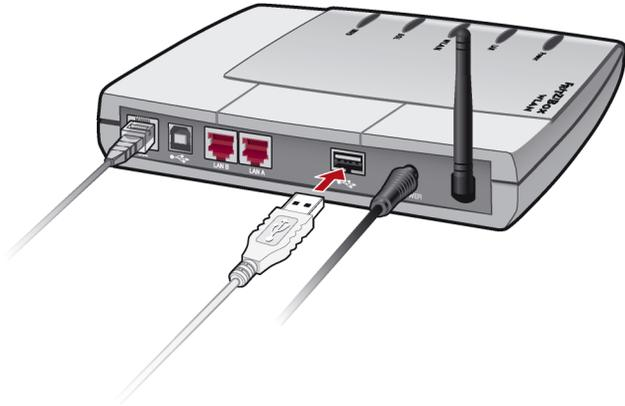
*Ein USB-Kabel am USB Host Controller anschließen*
