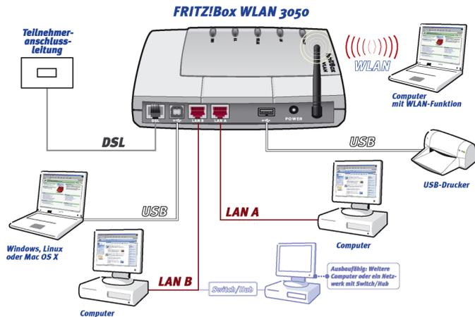
Anschlussmöglichkeiten der FRITZ!Box WLAN
