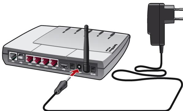
*Anschluss der FRITZ!Box WLAN an die Stromversorgung*
