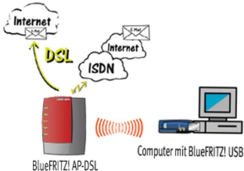
*Bluetooth-Verbindung mit dem ISDN-Profil CIP zwischen BlueFRITZ! USB und BlueFRITZ! AP-DSL*
