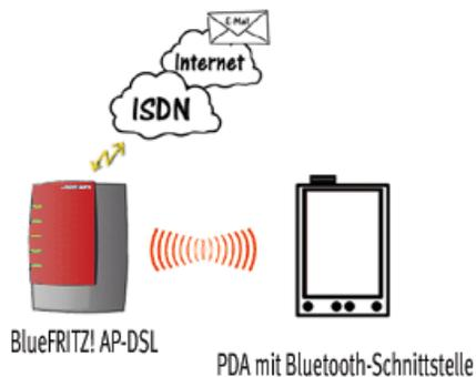
*Bluetooth-Verbindung mit dem DUN-Profil zwischen einem PDA und BlueFRITZ! AP-DSL*
