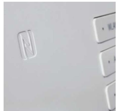
NFC-fähige Smartphones können sich die WLAN-Einstellungen durch Auflegen an der Front des Speedport W925V abholen.
