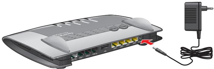
Raccordement à l'alimentation électrique
