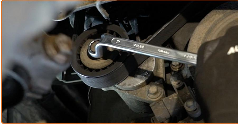
Ziehen Sie die Spannrolle des Keilrippenriemens beiseite. Verwenden Sie Ring-Gabelschlüssel Nr. 15.
