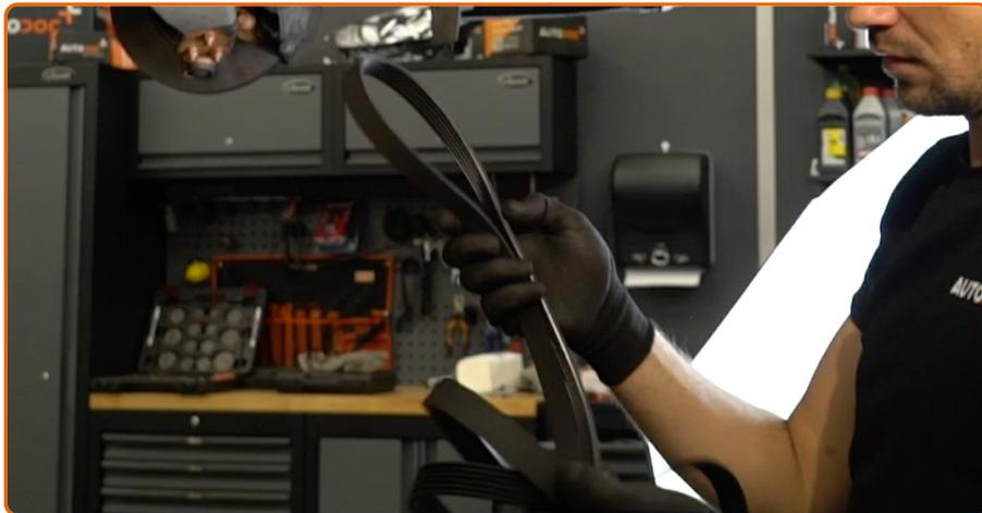
Entfernen Sie den Keilrippenriemen.
