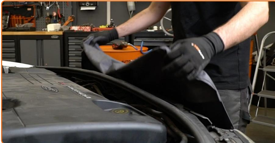
Entfernen Sie die Kotflügel-Abdeckung.
