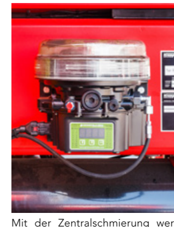
Mit der Zentralschmierung werden alle Schmierstellen automatisch mit Fett versorgt, auch an schwer zugänglichen Stellen.
