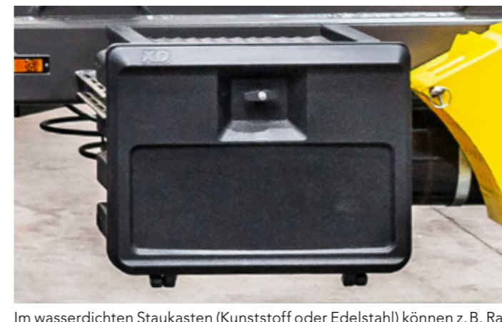
Im wasserdichten Staukasten (Kunststoff oder Edelstahl) können z. B. Ratschengurte geschützt untergebracht werden.
