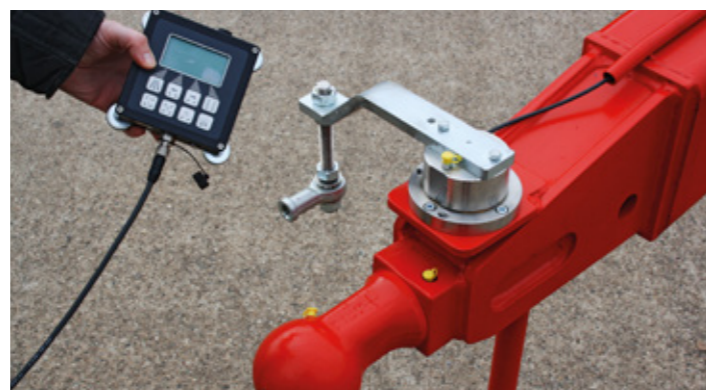
Bei der elektrisch angesteuerten Zwangslenkung kann der Fahrer durch verschiedene Programme die Lenkreaktionen des Anhängers aktiv beeinflussen.
