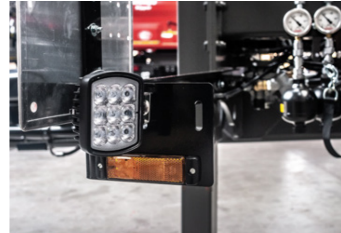
LED-Arbeitsscheinwerfer vorne oder im Fahrzeugheck (Option), Seitenmarkierungs- und Positionsleuchten gehören zum Standard.
