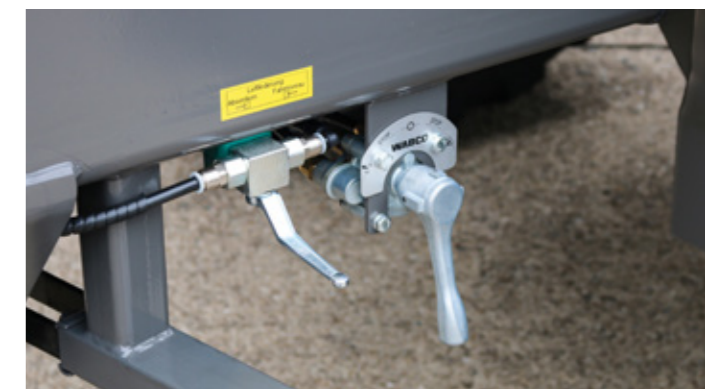
Die Luftfederung ist serienmäßig mit einem Umschalhahn ausgerüstet. Dieser verhindert das Absenken des Fahrwerks beim Kippvorgang. Optional kann darüber hinaus ein Heben-Senken-Ventil verbaut werden.
