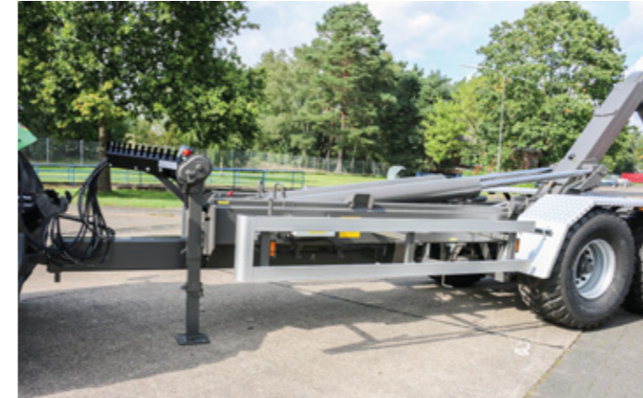
Der seitliche Anfahrtschutz erhöht die Sicherheit im Straßenverkehr.
