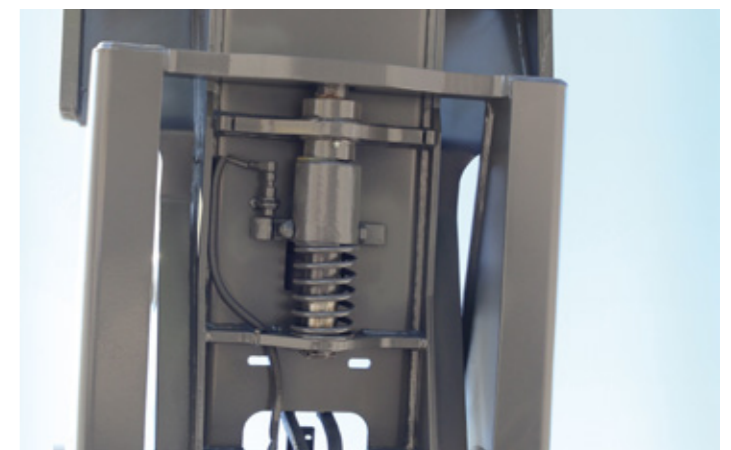
Bedienungsfehler ausgeschlossen! Ein Absetzen des Containers ist nur dann möglich, wenn der Schubarm vollständig eingezogen ist. Andernfalls wird der Absetzrahmen automatisch mit dem Kipprahmen verriegelt.
