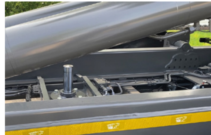
Der Ankipp-Hilfszylinder (Startzylinder) erleichtert das Kippen der Behälter im abgesenkten Zustand. Das ist besonders sinnvoll, wenn ein kurzer Überhang beim Kippen gewünscht wird.
