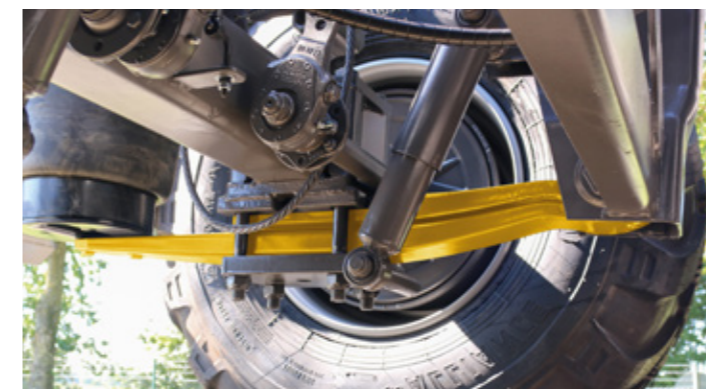
Bei Volumencontainern mit hohem Schwerpunkt und bei stark unebenen Gelände raten wir zu einem Fahrwerk mit Zweiblattlenkern zur Verbesserung der Standsicherheit.
