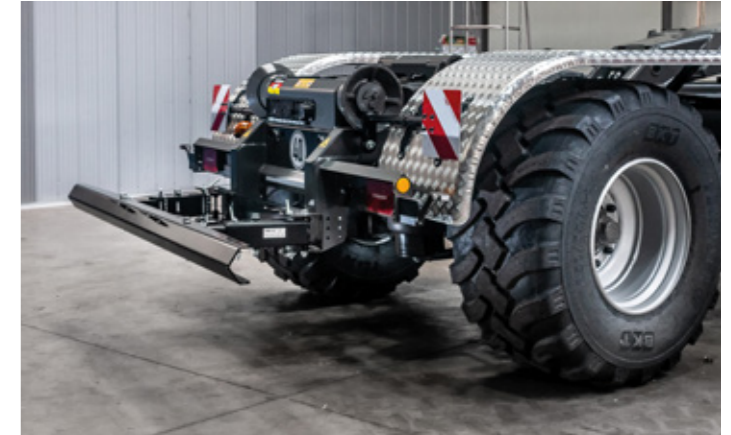
Der faltbare Unterfahrtschutz (Nutzhub 50cm) lässt auch den Transport von Containern mit Überlänge zu.
