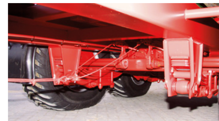
Exportversion: Bei der Ausführung mit Parabelfedern und hängenden Achsen ist die Bauhöhe sehr niedrig. Eine hydraulische Hinterachsabstützung entlastet die Zugmaschine beim Aufziehvorgang.
