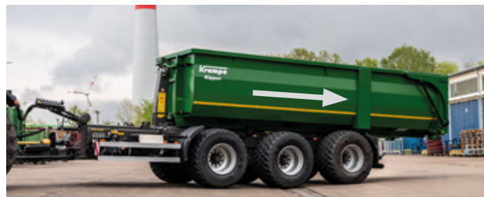
Alle Hakenliftanhänger von Krampe sind serienmäßig mit einem Schubarm ausgerüstet (Hub 1,00 bis 1,65m, modellabhängig).
