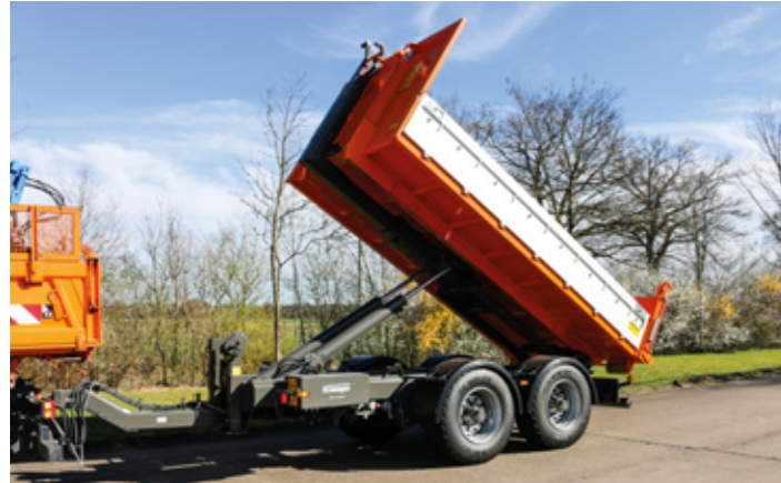
Der steile Kippwinkel von 47–55° (modellabhängig) lässt keine Wünsche offen. Kaum ein Hersteller bietet ein so umfangreiches Programm an Abrollkippern und Sonderzubehör. Nutzen Sie unsere jahrzehntelange Erfahrung!
