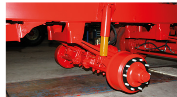
Kaum ein Hersteller hat so viel Erfahrung im Bau hydraulischer Fahrwerke wie Krampe. Die Schutzrohre verhindern Steinschlag auf den doppeltverchromten Kolbenstangen.
