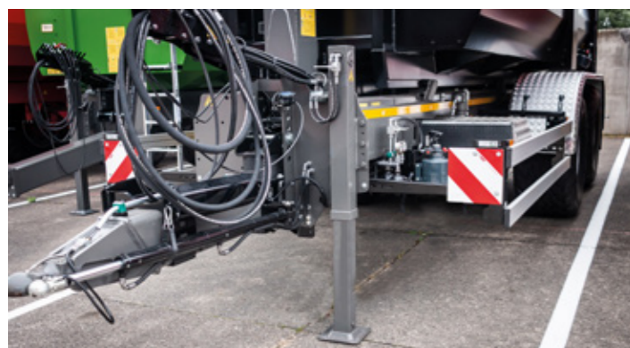
Ein hydraulischer Stützfuß erleichtert das An- und Abkoppeln des Anhängers und beschleunigt das Abstellen.
