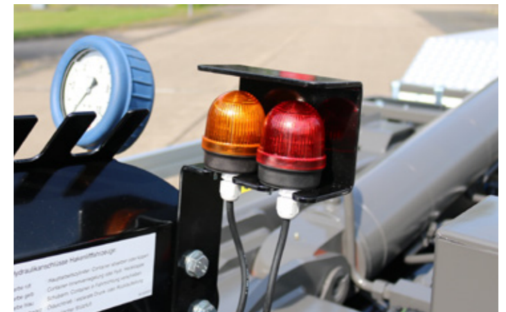
Ab der Baureihe THL 16-L werden unsere Hakenliftanhänger serienmäßig mit Kontrollleuchten ausgestattet. Bei einer Funksteuerung werden die Kontrollleuchten durch eine digitale Anzeige per Monitor ersetzt.
