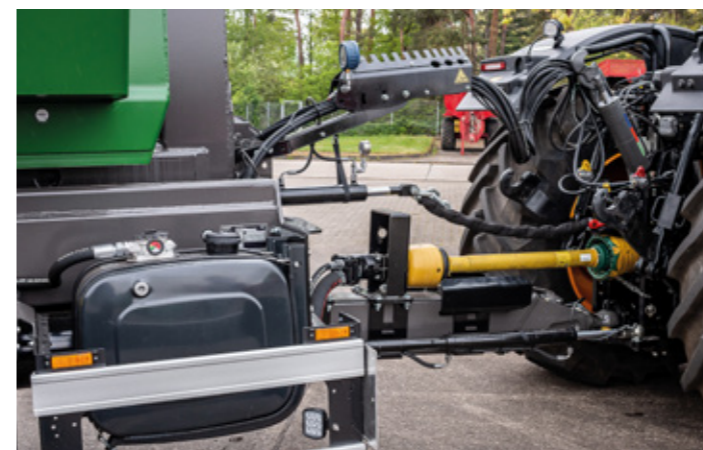
Für alle Abrollkipper bis 25t Hubkraft reicht die Schlepperhydraulik (200bar) aus. Eine eigene Ölversorgung mit Zapfwelle ist auf Wunsch lieferbar. Im Lieferumfang ist eine Funk-Fernbedienung enthalten.
