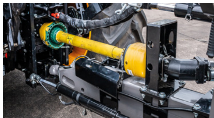
Die sehr schlanke Gestaltung der Zugvorrichtung sorgt für einen besonders engen Einschlagwinkel. Eine Zwangslenkung mit Normpunktanschluss hält Ihren Anhänger sicher in der Spur – auch bei hohen Geschwindigkeiten, schlammigen Böden und bei der Rückwärtsfahrt – zudem schont sie die Bereifung und das Fahrgestell.
