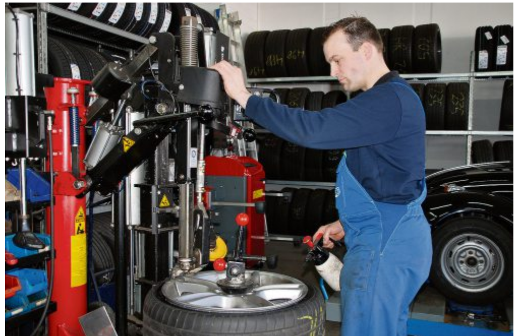
Mitarbeiter Hendrik Nykamp zieht mit Hilfe der Maschine den Reifen von der Felge ab. Moderne Ausstattung ist bei Reifen Kamps selbstverständlich. Fotos: Bitting
