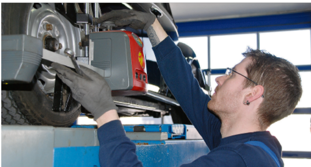
Konzentriert stellt Mitarbeiter Dennis König das Achsvermessungsgerät am Reifen eines Käfers ein. Fotos: Bitting
