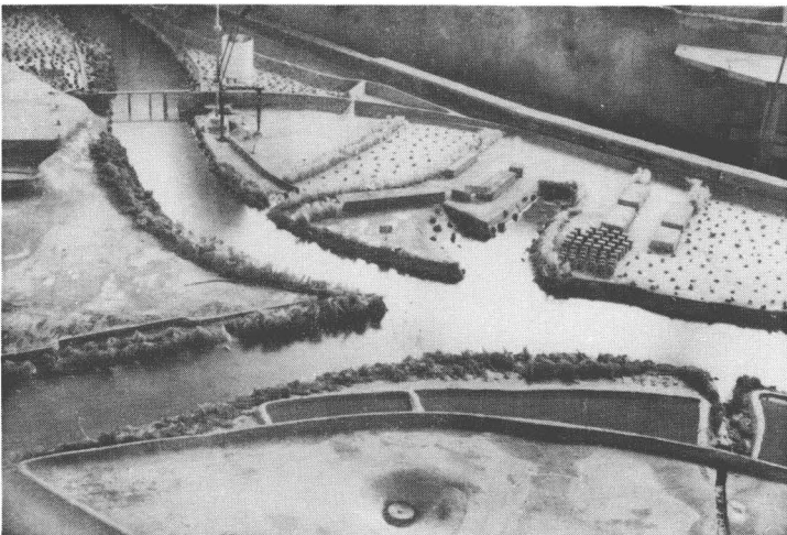
Tidemodell Untere Hunte in Halle I: Oben: Herstellung des Modells. Mitte: Blick auf die Weser und Hunte stromauf. Unten: Ausschnitt aus dem Modell.
