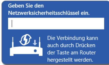
5. Für diesen Schritt haben Sie zwei Minuten Zeit: Drücken Sie an der FRITZ!Box so lange auf den Taster „W“, bis die Leuchtdiode „WLAN“ blinkt.
