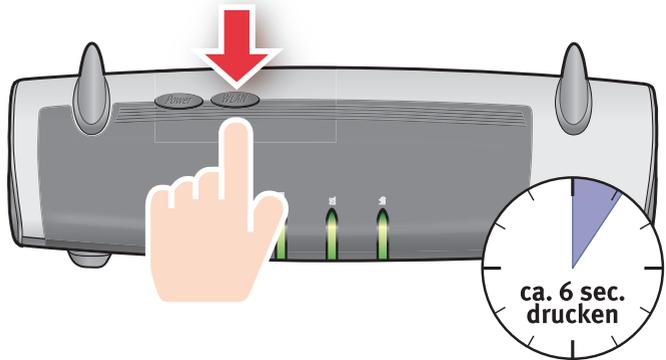
Die WLAN-Verbindung wird hergestellt.
