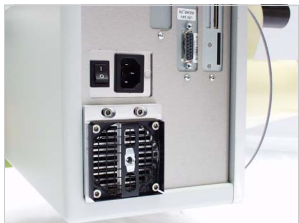
[79] Filterhuset er afmonteret.
