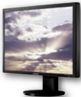
Samsung TFT SyncMaster 305T: 30-Zoll Widescreen-Display mit PVA-Panel, 2.560 x 1.600 Bildpunkten, Kontrastverhältnis 1.000:1, Helligkeit von 400 cd/m 2 , DVI-D-Anschluß.
