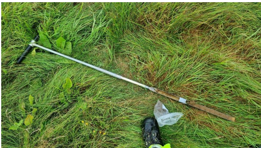
Figur 6. Sticksonden som användes till jordprovtagning i fältomgång 2. Halvcylindrisk bi-partite gouge auger, 500 x 30 mm innerdiameter av märket Eijkelkamp (04.01/04.02 core samplers).
