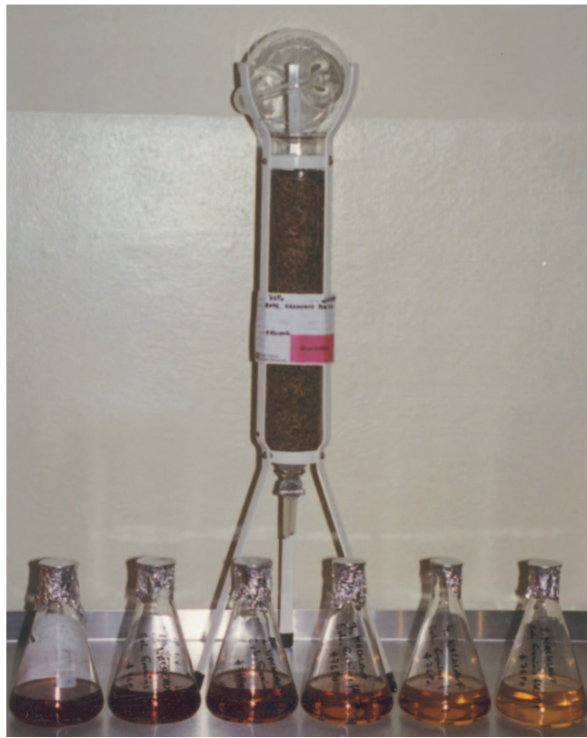
Herstellung von Fluidextrakten durch Perkolatation im Kleinmaßstab in Fürth/Bayern
