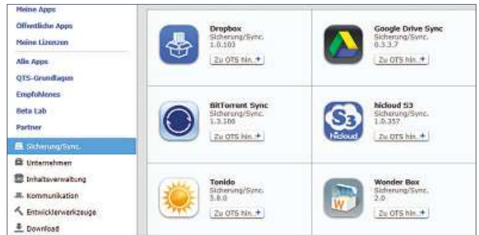
Cloud-Speicher lassen sich mithilfe von Apps direkt in NAS-Systeme von Synology und Qnap (im Bild) integrieren
