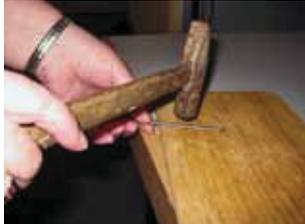
Schlage mit einem Hammer mehrmals seitlich auf einen metallischen Gegenstand (Nagel), der auf einer harten Unterlage liegt! Überprüfe mit deiner Hand die Temperatur des Nagels vor und nach dem Schlag!
