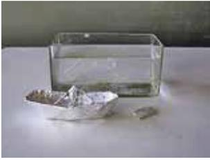
Nimm zwei gleich große Stücke Alufolie, die dadurch automatisch die gleiche Masse haben! Forme aus einem Stück eine Kugel und drücke sie fest zusammen! Bastle aus dem zweiten Stück ein Schiff! Setze beide auf eine Wasseroberfläche! Was passiert?
