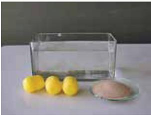
Nimm drei leere Kinderüberraschungseier oder ähnliche fest verschließbare Behälter mit gleichem Volumen als U-Boot! Finde heraus, wie du das U-Boot befüllen musst, damit es im Wasser schwimmt, abtaucht oder im Wasser schwebt! Geeignete Füllmaterialien sind Sand und Wasser.
