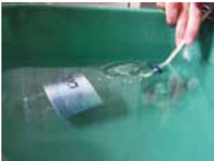
Tauche eine offene Wasserflasche vollständig unter Wasser (Entferne möglichst alle Luftblasen.)! Blase mit einem gebogenen Trinkstäbchen Luft in die Flasche! Beobachte! Du kannst jetzt auch die Luft wieder aus der Flasche saugen.
