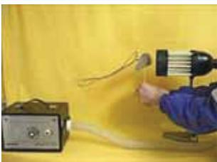
Halte verschiedene Probekörper (ganze/geteilte Tischtennisbälle, ausgeblasene Eier) in die Strömung und beobachte die Fäden vor und hinter dem Körper!
