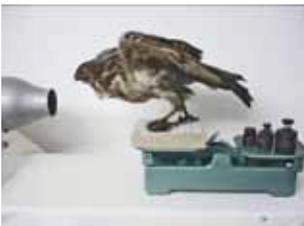
Befestige auf einer Tafelwaage verschiedene Flugobjekte
