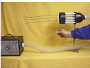
Baue aus Holzstäbchen und leichten Fäden verschiedene Fadensonden! Untersuche damit die aus einem Gebläse, z. B. Föhn, kommende Luftströmung!
