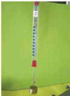
Bestimme die Gewichtskraft der Wägestücke mithilfe des Federkraftmessers!
