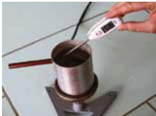
Fülle ein Becherglas halbvoll mit Wasser! Stelle es auf die Heizplatte! Miss mit einem Thermometer die Temperatur vor und drei Minuten nach Einschalten der Heizplatte!
