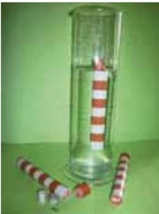
Der zylinderförmige Hohlkörper hat ein Volumen von  $100 \text{ cm}^3$ . Er kann mit 10-g-Massestücken befüllt werden. Dadurch kann dieser Hohlkörper schwimmen, schweben oder sinken.
