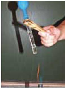
**Durchführung:** Fülle ein Reagenzglas halb mit Wasser! Verbinde die Öffnung mit einem Luftballon! Erhitze vorsichtig das Wasser!
