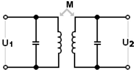
Bandfilter mit fester Kopplung durch eng benachbarte Spulen haben eine größere Bandbreite.
