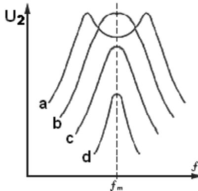
An der Einsattelung der A-Kurve ist überkritische Kopplung erkennbar.
