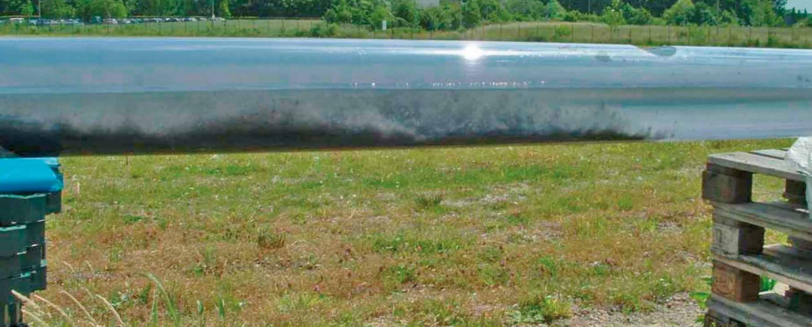
Transport der Ablagerungen durch eine Schwallwelle.
