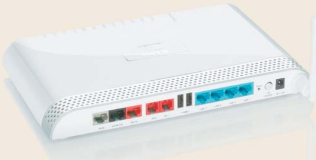
Schnittstellen satt: D-Links Horstbox gehört zur Generation der neuen IADs und vereint alle Sprach- und Datenschnittstellen in einem Gerät (Abb. 2).
