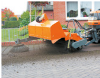
bema Kehrmaschine mit bema Wildkrautbürste und Seitenkehrbesen
