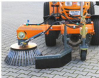
Flexibel im Einsatz dank teleskopierbarer Seitenverschiebung (300 mm)
