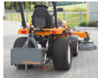
Aufrüsten mit dem bema PowerPack - Hydraulisches Antriebsaggregat
