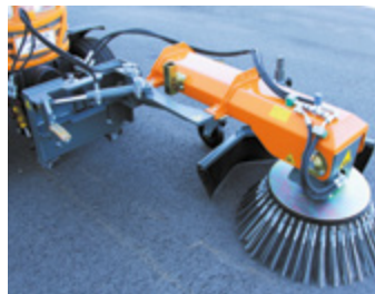
Hydraulische Schwenkeinrichtung, links ca. 85 °
