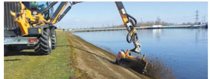
Kehrmaschine aus dem Baukasten: bema 25 mit Wildkrautbürste, ohne Sammelwanne, Anbau Bagger (Sonderbau)
