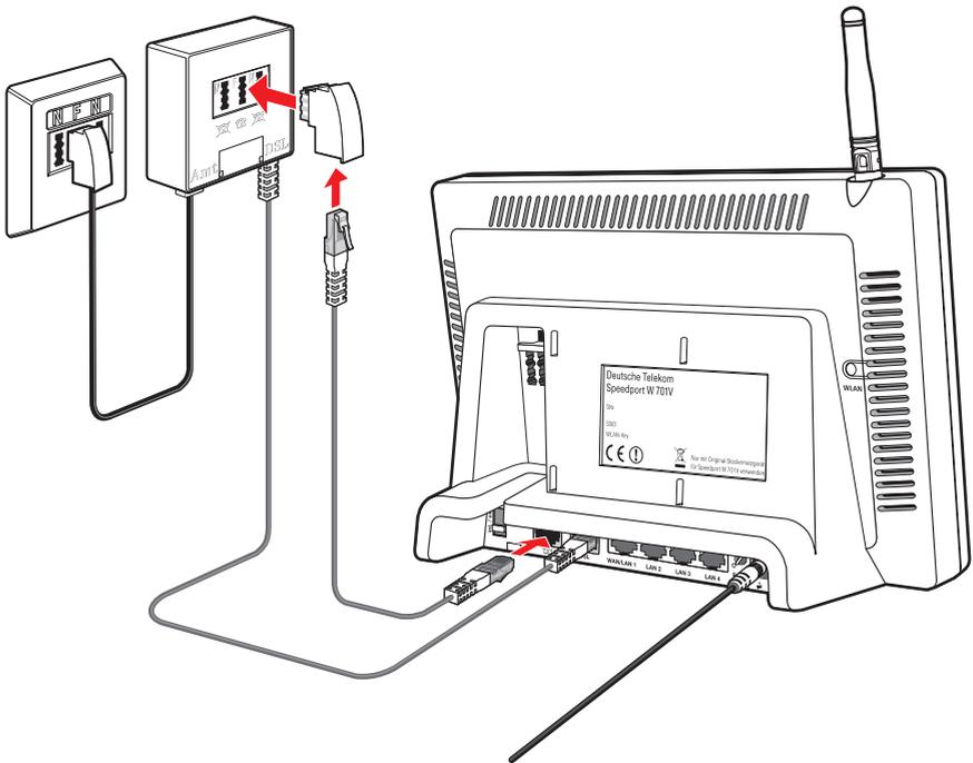
Anschluss des Speedports W 701V an DSL und den Standard-Anschluss über den DSL-Splitter
