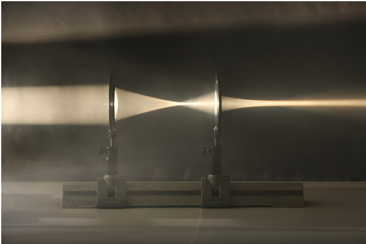
Abbildung 4: Zwei Sammellinsen, ein paralleles Lichtbündel und etwas Kunstnebel – Demonstration der Lichtsammelwirkung eines Fernrohres.
