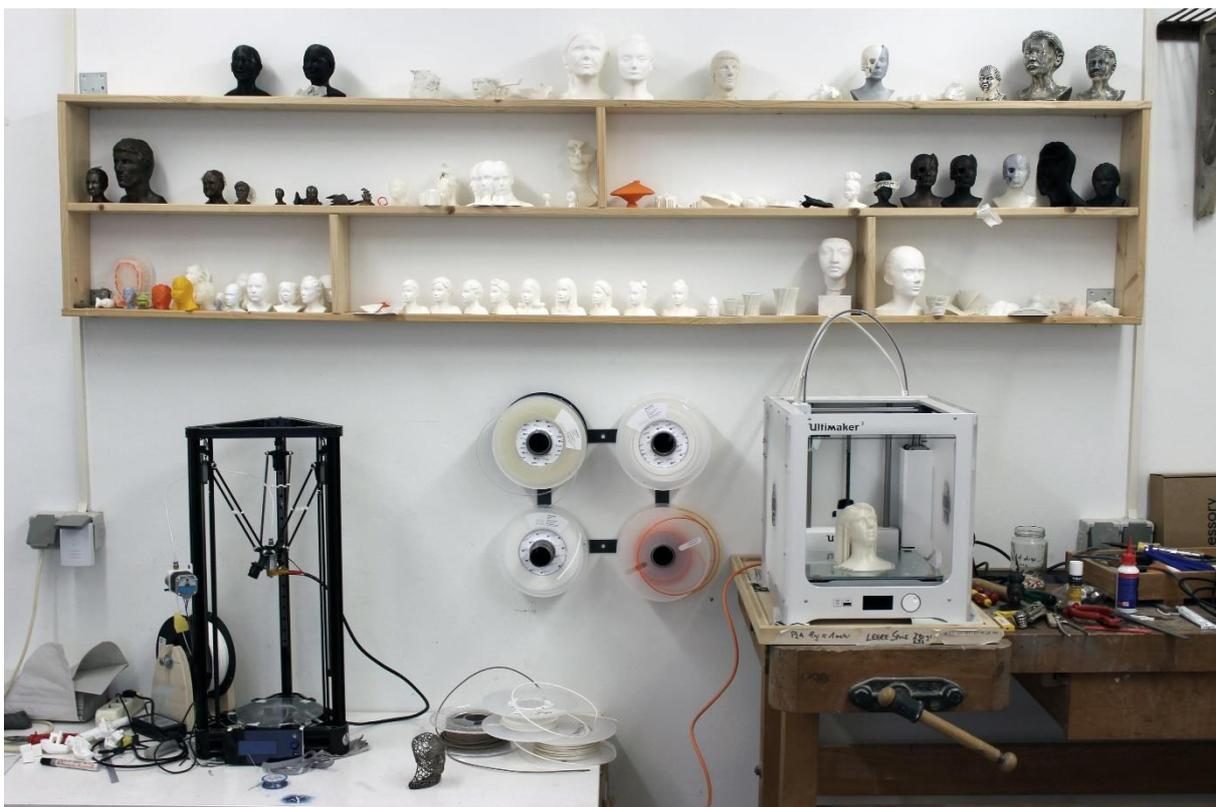
Abbildung 2.8: 3D-Druckstation im Steinhof mit Ultimaker 3 und Delta-Drucker, unterschiedlichen Filamenten und Druckergebnissen (Foto jM)
