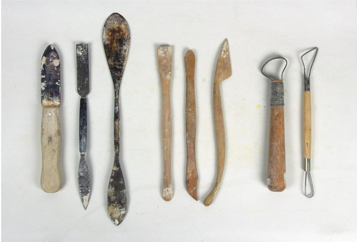
Abbildung 3.3: Werkzeuge für die Tonbearbeitung, verschiedene Metallspachtel und -spatel, Modellierhölzer und –schlingen (Foto Ch. Küpper)
