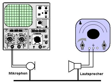
Durch Erhöhung der Frequenz der ausgesandten Schallwelle (man erkennt dies z.B. am Schirmbild des Oszilloskops bzw. an der Einstellung des Sinusgenerators) steigt die Höhe des Tons. Erhöht man die Amplitude der den Lautsprecher anregenden elektrischen Schwingung, so steigt die Lautstärke des vom Lautsprecher ausgesandten Signals. Die Ausschläge am Oszilloskop wachsen an.
